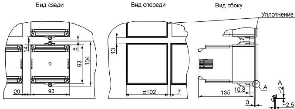
Рисунок 4.3 – Прибор в корпусе Щ4, установленный в щит толщиной 3 мм
